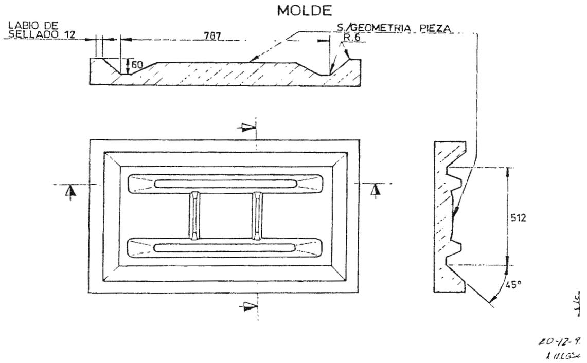
Figure 11. Simulation III. Geometry of die
