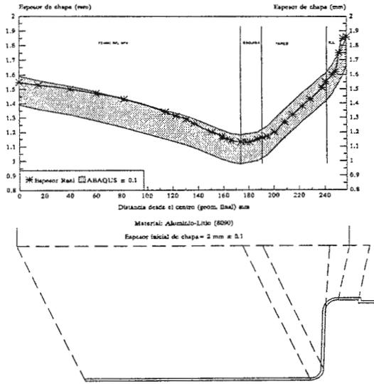
PREDICCIÓN DE ESPESORES CSP
